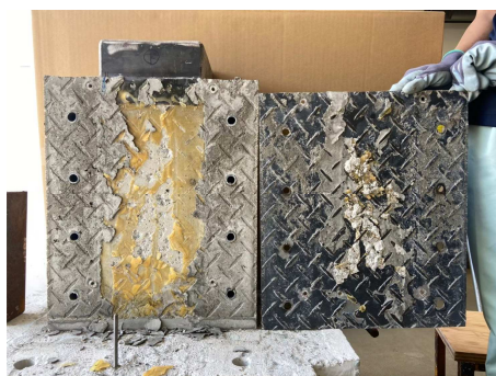
写真-2 補強試験体 R22-0-PP1 の補強鋼板除去状況
