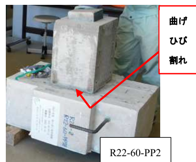
写真-1 補強鋼板除去後の補強試験体
