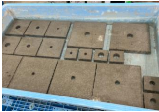
写真一1 養生の様子
