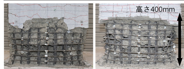
図-4 破壊状況 (左: NRC ケース, 右: 3DRC ケース)
