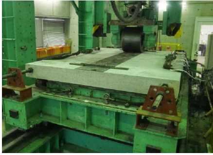
写真-1 輪荷重走行疲労実験
