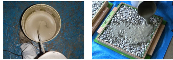
(a) モルタルの製造 (b) モルタルの充填 図-2 プレパックドコンクリート試験体の製造
