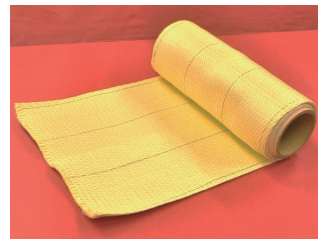
写真-1 AFRP シート
