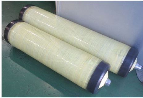
写真-1 FCEV用高圧水素タンク
