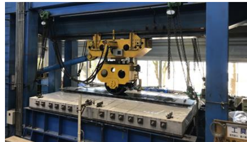
写真-7 輪荷重走行試験の状況
