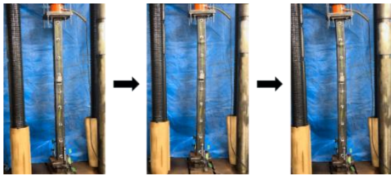
写真-6 座屈の進行状況（角形）
