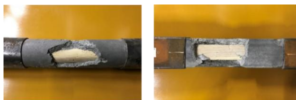
写真-4 実験後の内部の木材 (長柱, 養生期間4~8週間) 3)
