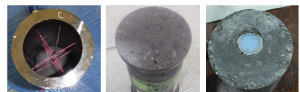
試験体内部 端面研磨 湿度センサ埋込
