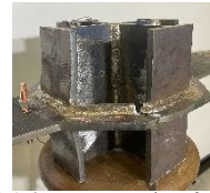
(c) 柱フランジ局部変形
