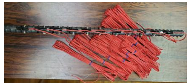
図-2 ひずみゲージ貼付状況（20dシリーズ試験体）
