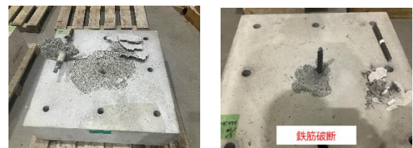
試験体 5 (スラブ配筋無し) 試験体 6 (スラブ配筋有り) 写真-3 スラブ配筋の影響 (破壊状況)
