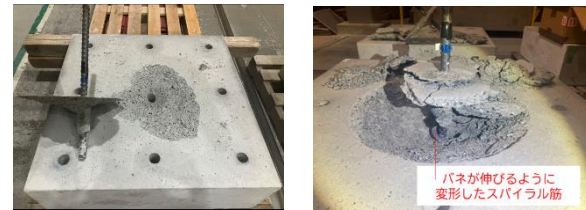
試験体 3 (スパイラル筋無し) 試験体 4 (スパイラル筋有り) 写真-2 スパイラル筋の影響 (破壊状況)
