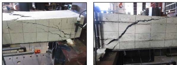
試験体 CB-2 試験体 DBUL-RI 写真-8 支点部付近の破壊状態
