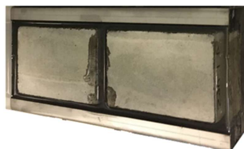
写真-1 微生物腐食実施前の試験体
