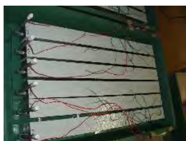
図－2 供試体の乾湿繰返し状況
