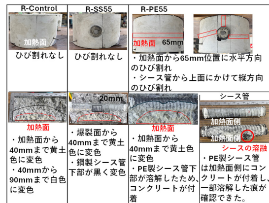
図-8 加熱後のリング供試体の損傷状況
