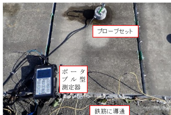
図-3 3電極法の測定の様子
