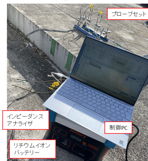
図-4 4電極法の測定時の様子
