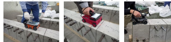
G社製 N社製 P社製 写真-2 試験体の配置と測定状況 (室内試験)
