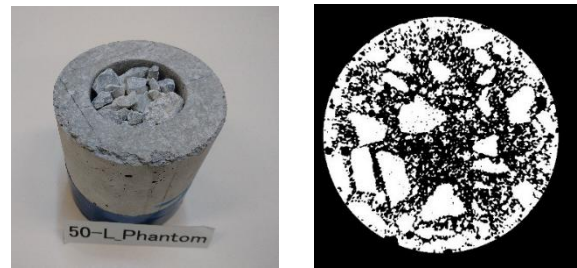
写真-2 Phantom 供試体 図-8 粗骨材の二値化画像
