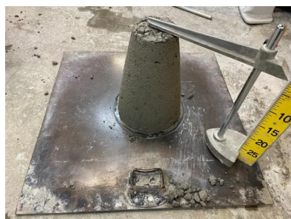
(b) 木粉添加コンクリート(5 vol%) 写真－2 スランプの状態（木粉添加）
