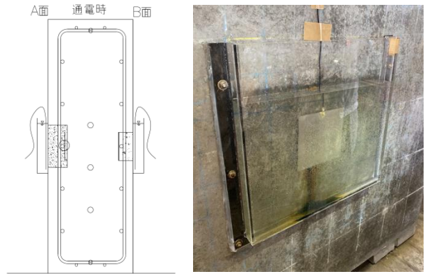
図－３ 電気泳動による通电状況
