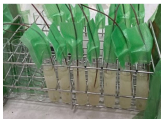
写真-1 熱電対の設置状況
