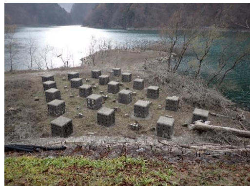
写真-1 長期暴露試験実施状況
