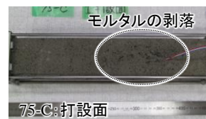
図-2 凍結融解によるコンクリート供試体の劣化 (画像左側 : 下部拘束端板側, 画像右側 : 可動板側)
