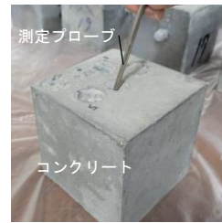
写真-1 近赤外分光法の測定状況
