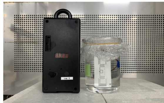
図-4 RFID センサーによる温度測定の様子
