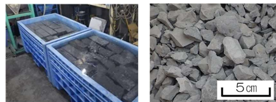
水中養生状況
