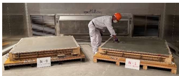
写真-2 左官職人によるこて押え感覚の確認状況
