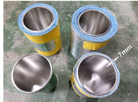
図-2 保温材による水和熱の放熱抑制
