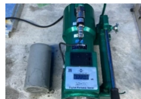
写真－3 ポータブル圧縮試験機
