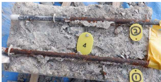
鉄筋 1・2 (錆び落とし無し), 内部側, グレード 4
