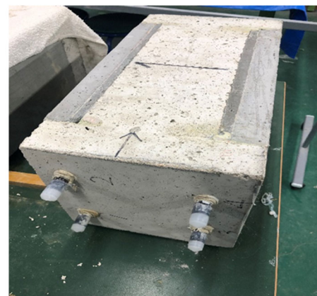
写真-1 断面修復を行った供試体
