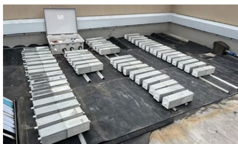
写真-1 供試体暴露状況
