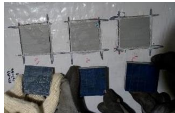
写真-4 測定箇所② 接着試験後の状況
