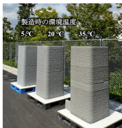
写真-2 屋外暴露試験の状況
