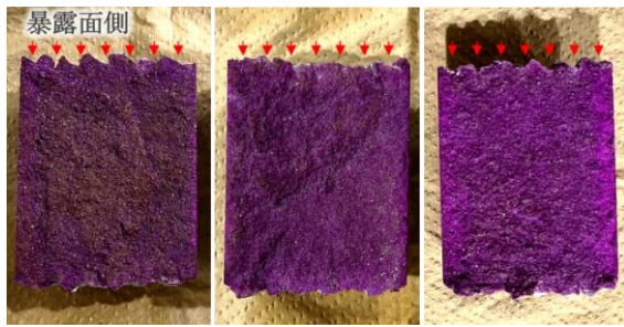
写真-5 中性化深さの測定結果 (左:5℃, 中央:20℃, 右:35℃)
