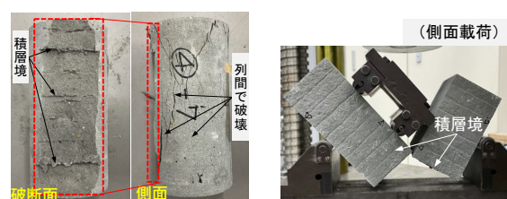
(a) 圧縮破壊（上面コア）(b) 曲げ破壊（直交切出し） 写真-1 圧縮と曲げ破壊状況の一例（材齢 28 日）
