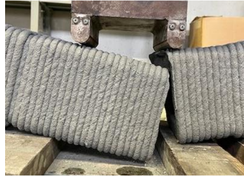
図-8 曲げ強度試験体の破壊状況
