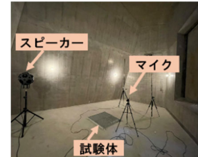
写真-5 測定時の残響室内の様子
