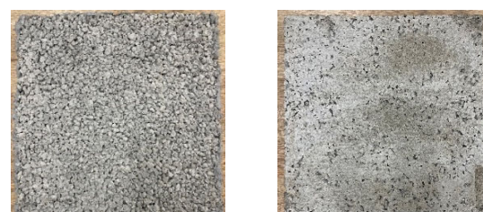
写真－3 POC 同一試験体の表面の様子 (V R =15%)
