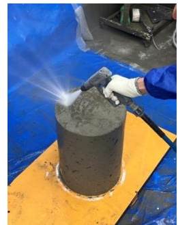
写真-3 洗出しの状況
