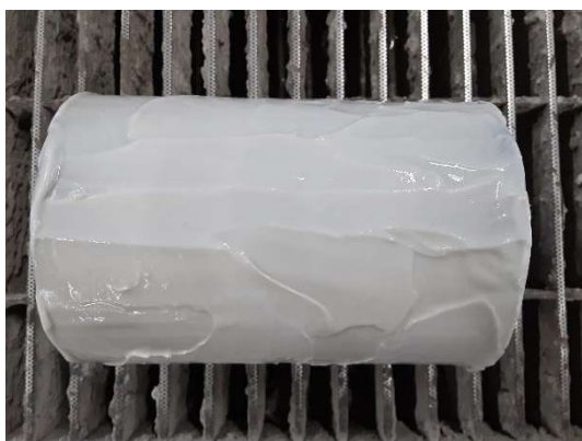
写真－6 試験体表面被覆状況
