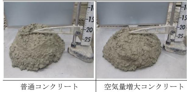
写真-2 スランプ試験状況
