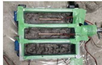
図-5 体積変化測定用供試体の打設状況
