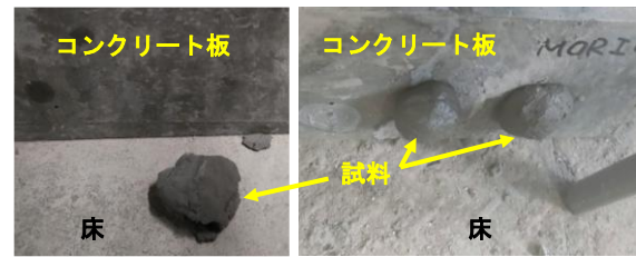
(a) Case1 FA のみ (b) Case2 LUSI-GP 図-3 チキソトロピー性の簡易試験の様子
