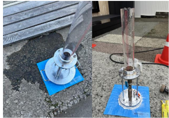
写真-2 現場透水試験の様子 (現場1, 現場2)
