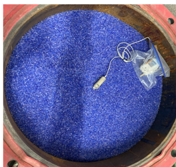
写真-1 炭酸化前のシリカゲルの状態
