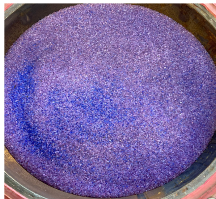
写真-2 炭酸化後のシリカゲルの状態
