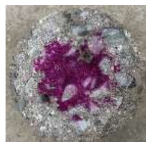
写真-5 普通コンクリートの炭酸化の様子
