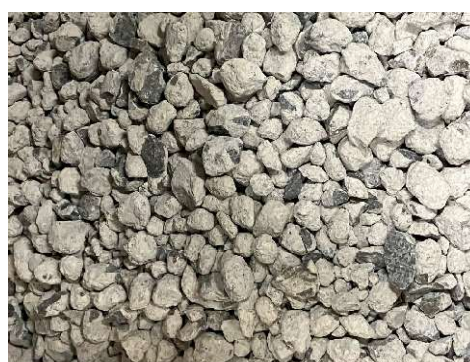
写真-2 粒状化再生粗骨材の外観
