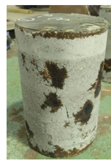
写真-3 実験終了後に脱型したR-CCCの破壊状況
