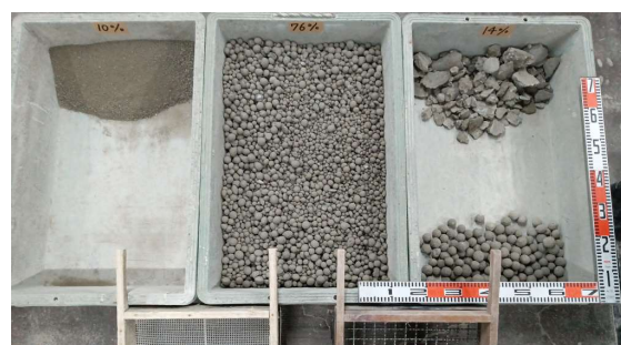
写真-5 傾胴型ミキサで製造した粒状化再生骨材
