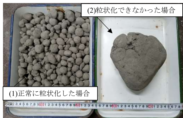
写真-4 ポリプロピレン製袋の中で製造した粒状化再生骨材（左：No. 5, 右：No. 6）
