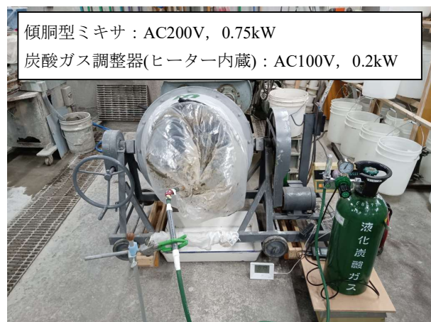
写真-3 傾胴型ミキサへの CO 2 封入状況
