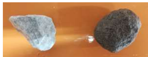
写真-1 粒状化前(左)と粒状化直後(右)の粗骨材
