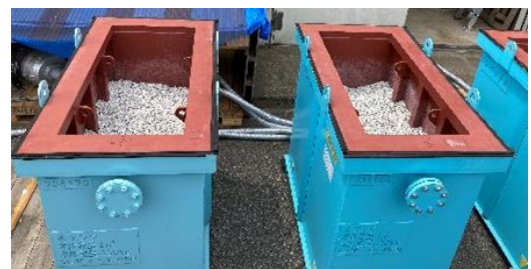
写真-4 再生粗骨材の炭酸化方法
