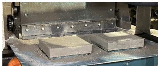
写真-7 即脱状況
