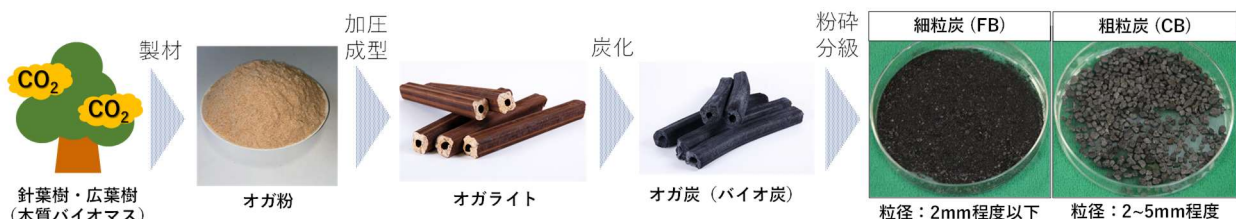
図-1 本検討で使用したバイオ炭の製造工程
